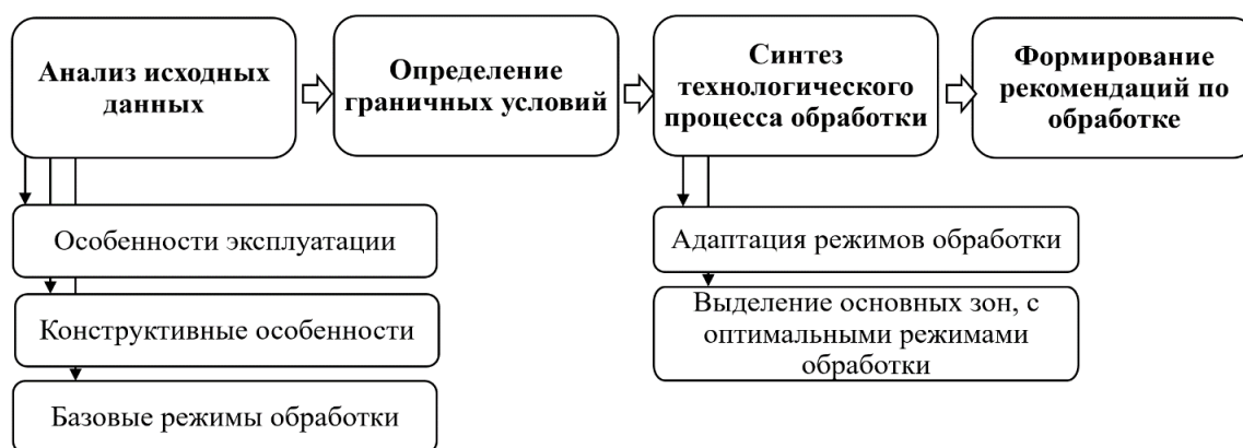
Рисунок 5. Блок-схема процесса адаптации процесса при обработке сложного криволинейного профиля ЛТ ГТД
